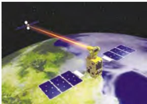
Figura 8. Ilustración del enlace por láser entre el satélite europeo ARTEMIS (a lo lejos) y el japonés OICETS (al centro de la figura). (Cortesía de NASDA) [http://spaceboy.nasda.go.jp/lib/satellites/oicets/g/oicets_009.jpg]
